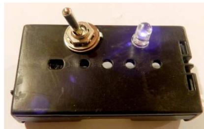
Ilustración 11: Prueba de funcionamiento del LED infrarrojo.
