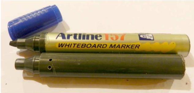
*Ilustración 4: Marcador abierto, sin punta y con los dos orificios para el pulsador*
