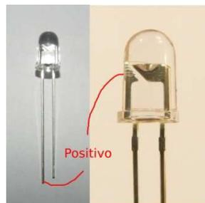
*Ilustración 6: Positivo del LED Infrarrojo*
